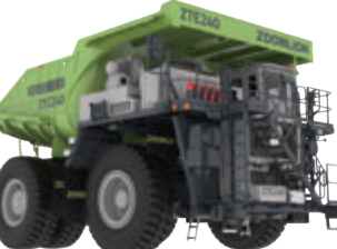
ZTE240 ▲ 106000 kg ▲ 104,5 kW/1800rpm ● 140,2 kW ● 136 t ⚡ 70 m³ (düz yüzey yükleme) 76 m³ (yiğün yükleme SAE 2:1 standartına göre)
